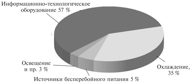
Рис. 1. Распределение энергопотребления типичного ЦОД
