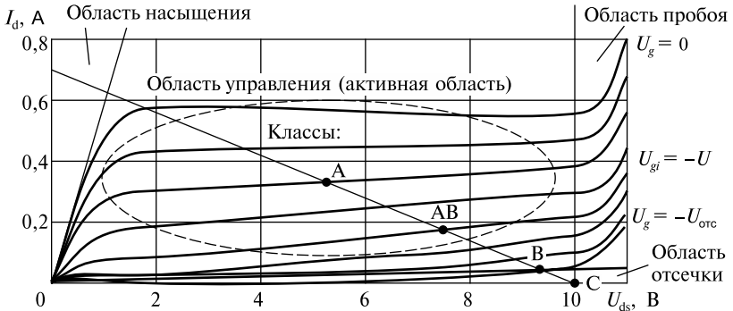
Рис. 1.2. Характерные области работы активного элемента автогенератора
