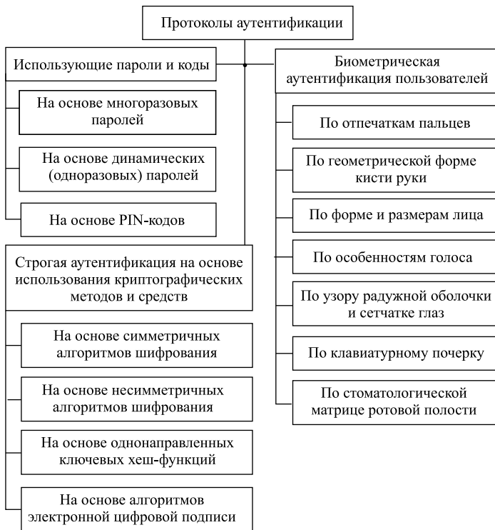
Рис. 1. Классификация протоколов аутентификации
